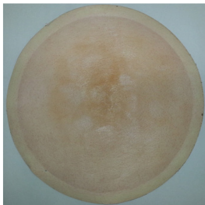
Figura 6 – Membrana Contaminada com Corantes depois do Tratamento das Águas Residuais pelo Processo de DMCD
