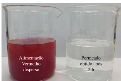
Figura 5 – Resultado Comparativo do Permeado Obtido depois do Tratamento por DCMD com a Alimentação (corante vermelho disperso)
