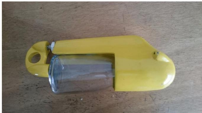
Figura 19 - Coleta de amostra com o DH 48
