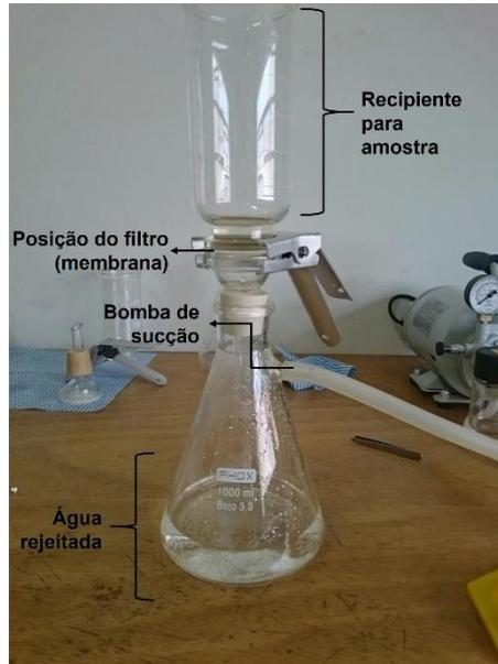
Figura 20 – Kit de filtração para determinação do sedimento em suspensão
