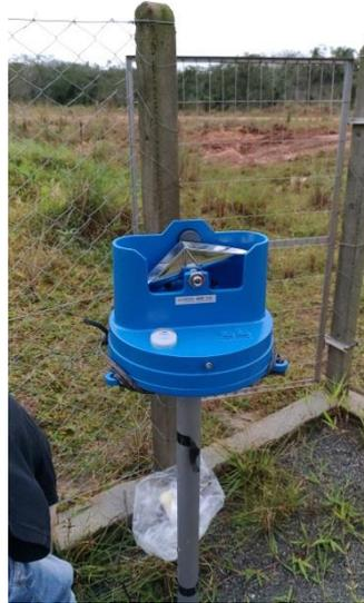
Figura 3 – Instalação pluviógrafo - PONTO 2
