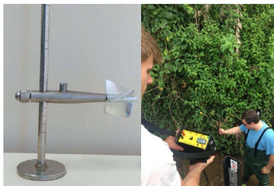
Figura 28: Medições de velocidades realizadas com micromolinete
