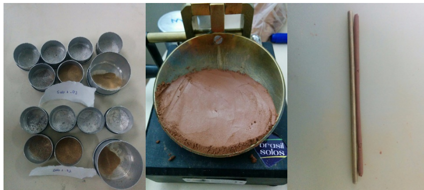
Figura 42: Ensaio realizados para determinação da granulometria, limite de plasticidade e liquidez dos solos da BHCUI
