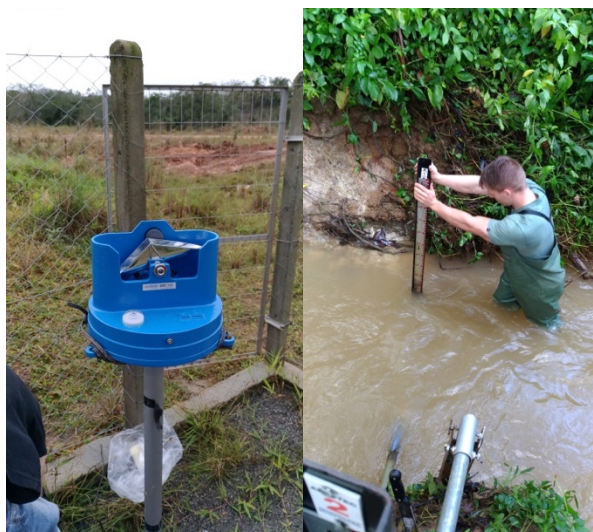
Figura 45: Pluviômetro em processo de limpeza (à esquerda) e nivelamento de régua linimétrica após evento extremo (à direita).
