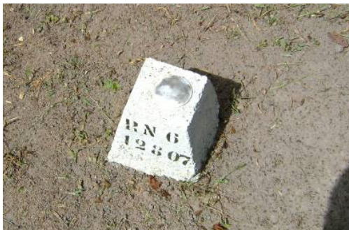
Figura 8: Exemplo de RN instaladas seguindo os padrões da ANA (Fonte: ANA, 2014).
