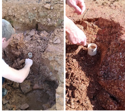
Figura 42: Ensaio realizados para determinação da granulometria, limite de plasticidade e liquidez dos solos da BHCUI
