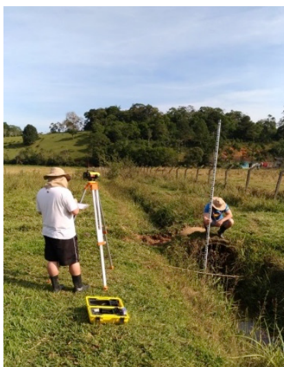
Figura 22: Levantamento topobatimétrico P4 em campo
