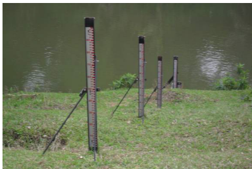
Figura 8: Exemplo de RN instaladas seguindo os padrões da ANA (Fonte: ANA, 2014).
